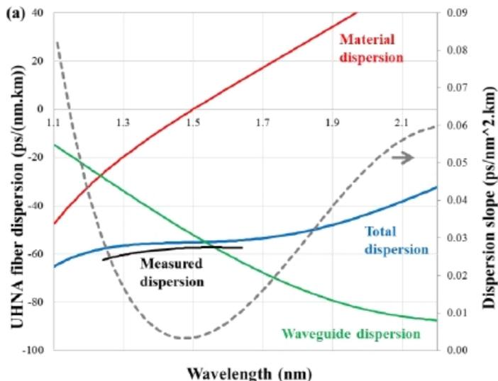
芯径（数值孔径）-->色散模拟计算结果
